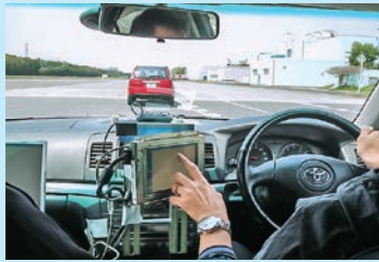
情報機器（カーナビ、スマホなど）の操作が運転に及ぼす影響を評価する実験
