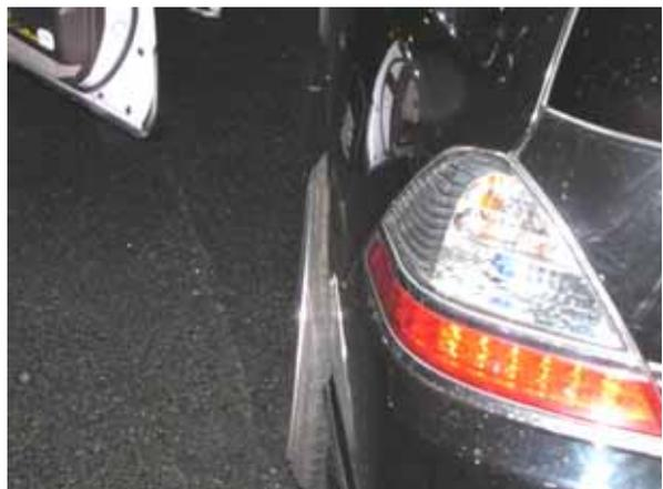
（不正改造車例：回転部分が突出した車両）
