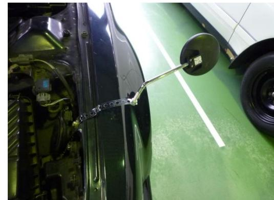
写真3 共締めによるポン付け
