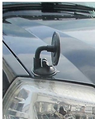
写真2 吸盤によるポン付け
