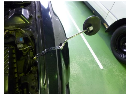
写真3 共締めによるポン付け
