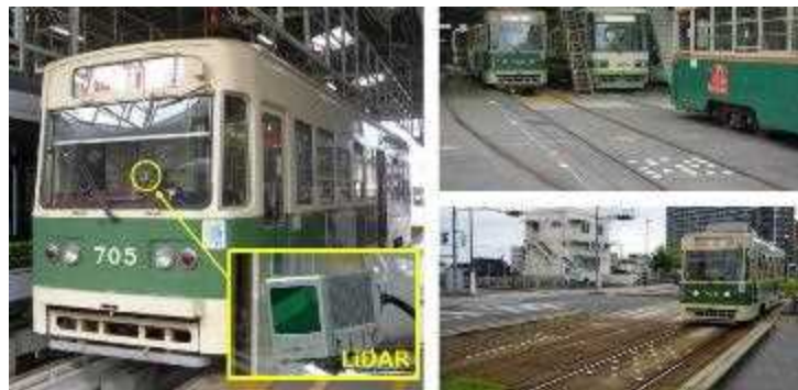
【LiDAR センサによって衛星測位を補完する手法の検証実験】
