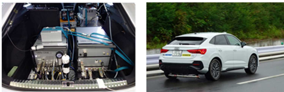
【車載式排出ガス測定システム】
