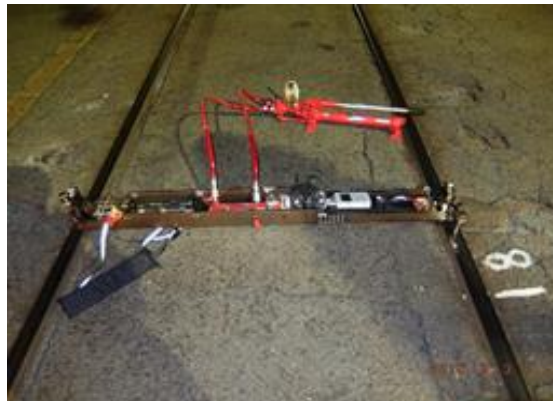
横圧作用治具を用いた軌間拡大リスクの評価
