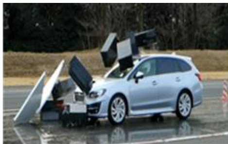
滑りやすい路面条件下での実験 ペダル踏み間違い時加速抑制装置の実験
