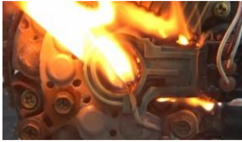
オルタネータ被油に関する発火実験
