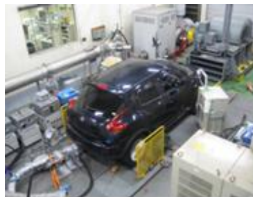
トランスミッションモデルを構築するためのシャシダイナモ試験
