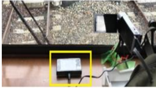
小型端末を用いた車両動揺の測定
