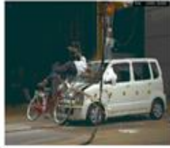
車両の正面に衝突した場合 車両の側面に衝突した場合 自転車と車両との衝突試験
