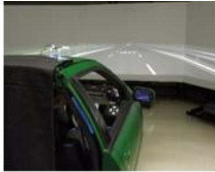
ドライビングシミュレータによる路面描画評価実験
