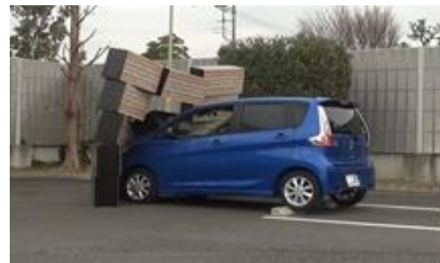
滑りやすい路面条件下での実験 ペダル踏み間違い時加速抑制装置の実験
