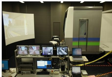
【列車運行システム安全性評価シミュレータ】
