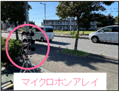
【図1 マイクロホンアレイを用いた測定の様子】
