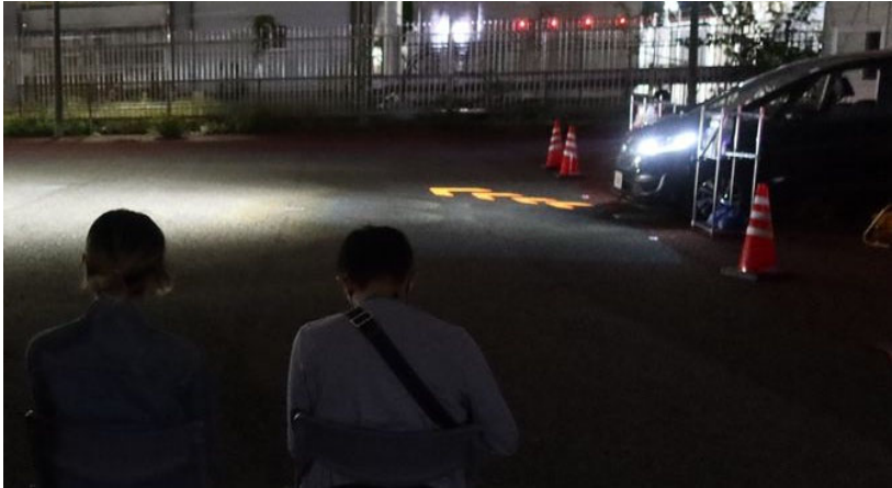
【信号灯路面描画評価実験の様子】
