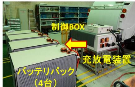
【図 重量電気自動車の電池容量の劣化度合いを検証するための充放電装置】
