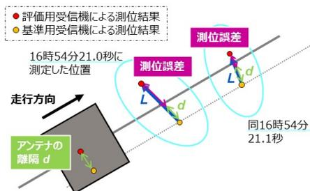
【図 長期的な衛星測位精度評価手法】
