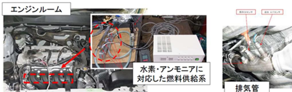
令和6年度では、令和5年度に改造を実施した車両にて、まずアイドリング状態で水素供給量を増加させながらガソリンの噴射量を低減させる
