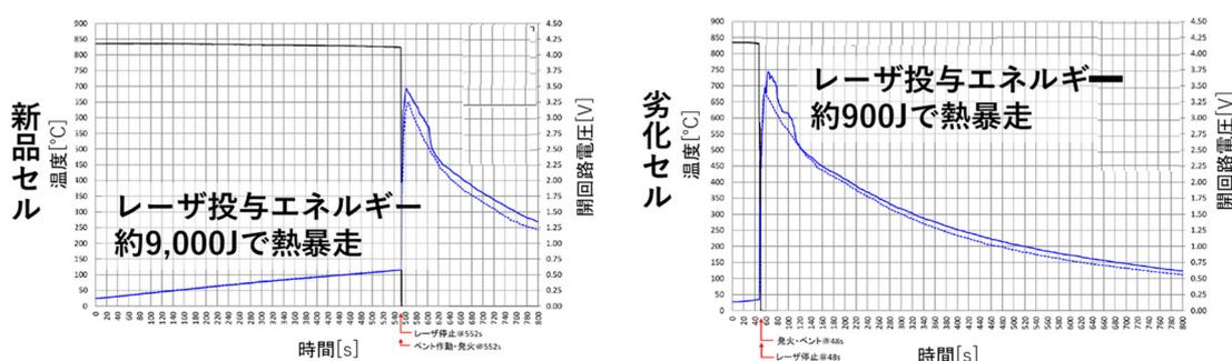
【図 新品セルと劣化セルでの熱暴走に至るまでに要する投与エネルギーの差】
