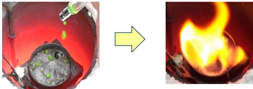
【エンジン冷却剤の燃焼性確認実験】
