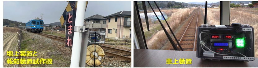
【第4種踏切安全通行支援システムの動作確認試験の様子】
