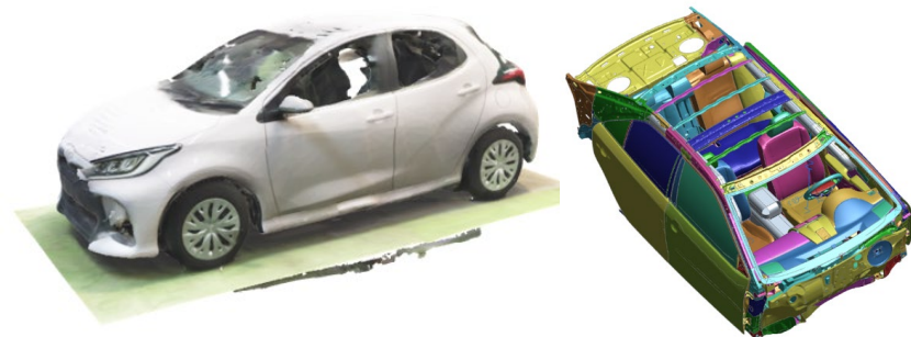
【3次元測定した車両の3Dモデル】
