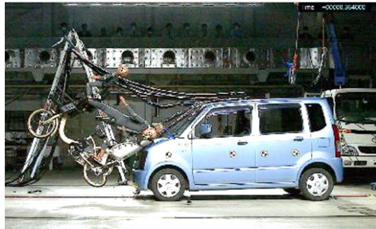
【子供乗せ電動自転車の追突実験】
