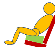
条件 3 腰部を前方に移動 (+100mm) した姿勢 学童用ブースタークッションを使用
