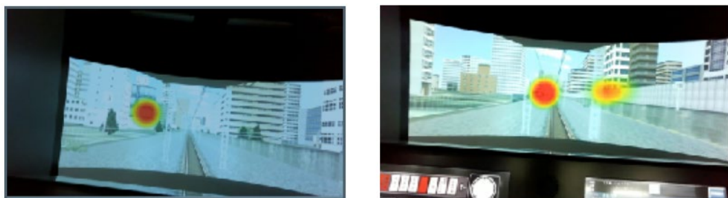
【図 被験者試験における視認行動の比較の例】
