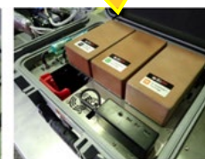
FLEX ・排出ガス成分 (CO、CO 2 、HC、NO、NO 2 、PM、PN) の計測モジュールを搭載
