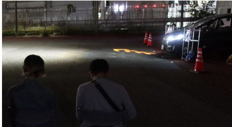
【信号灯路面描画評価実験の様子】
