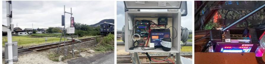
長期フィールド試験対象の第4種踏切 地上装置 車上装置
