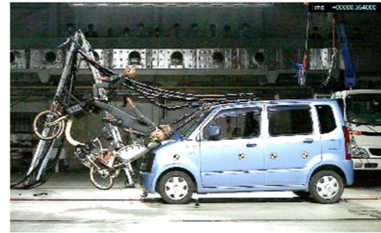
【子供乗せ電動自転車の追突実験】
