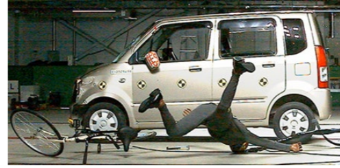
【自転車追突事故の衝突試験】
