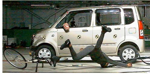
【自転車追突事故の衝突試験】
