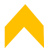
(a) 方向指示器路面描画の基本エレメント (シェブロン, アンバー)
