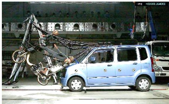
【子供乗せ電動自転車の追突実験】
