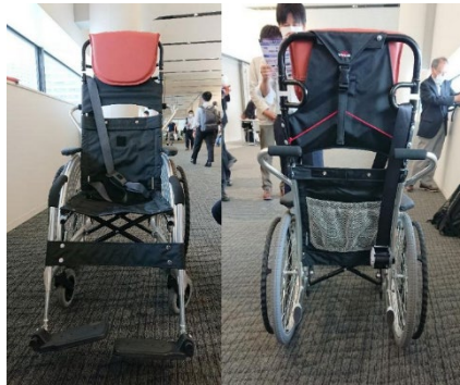
【シートベルトを備えた車載用耐G車椅子】
