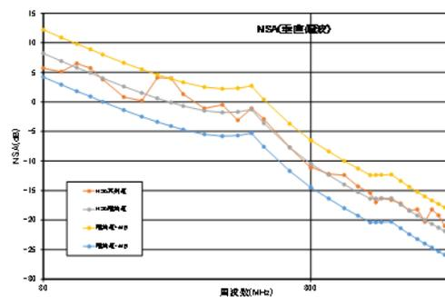
ESA 暗室の電波反射特性測定例
