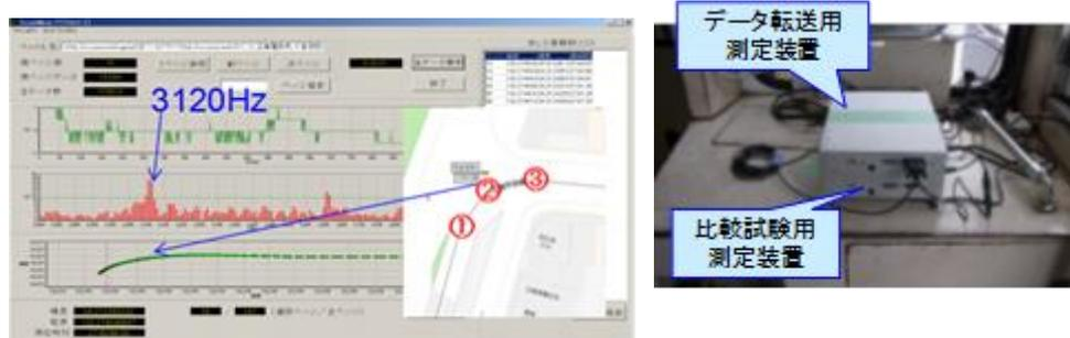
自動解析ソフトによるきしり音発生箇所の特定 自動収録データの確認試験
