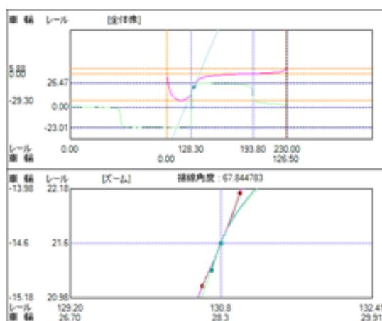
レールと車輪との接触角の算定例
