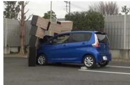
ペダル踏み間違い時加速抑制装置の実験
