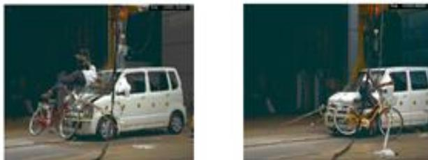
車両の正面に衝突した場合 車両の側面に衝突した場合
