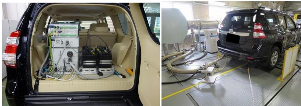
車載式排出ガス測定システム
