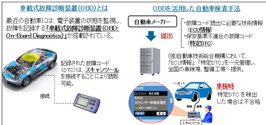
車載式故障診断装置を活用した自動車検査手法のあり方について
