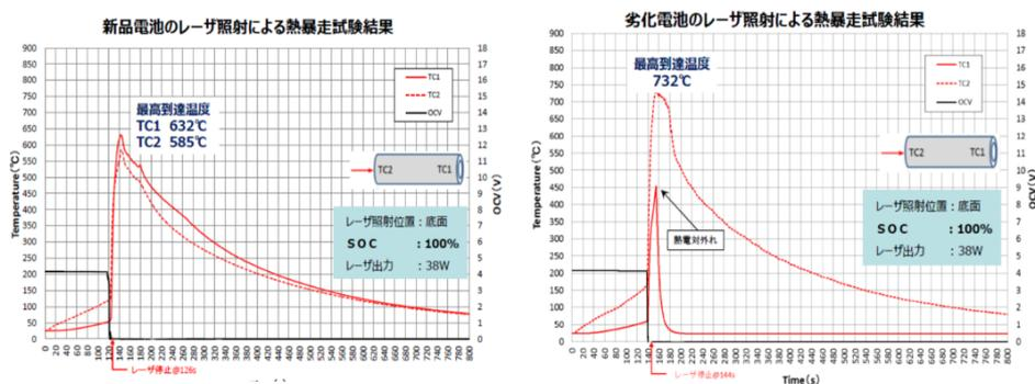
劣化したセルは新品に比べて、最高到達温度が100度上昇した。交通研として、劣化バッテリーの安全性低下を確認した。
