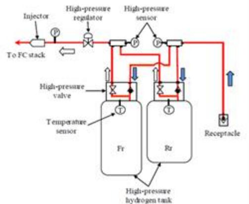
車載水素供給システムの概略図と温度・圧力測定位置の例
