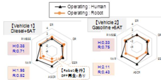
図 運転指標（運転ロボット vs.人間）
