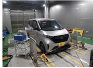
〈低温・高温可変シャシダイナモによる電気自動車の走行用 バッテリー への影響実験〉
