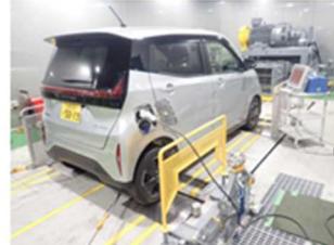
〈低温・高温可変シャシダイナモによる電気自動車の走行用 バッテリー への影響実験〉
