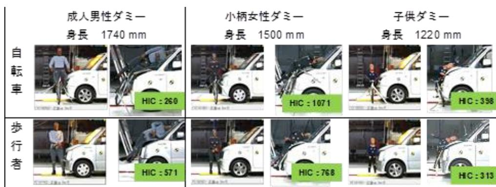
【実験条件及びダミー頭傷害値（車両速度 40km/h）】
