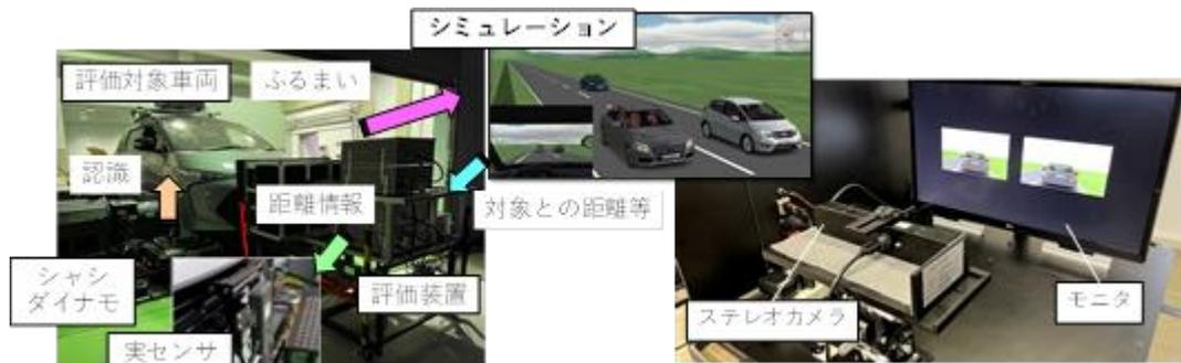
【評価装置を用いた実験室内における評価】
