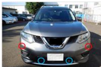
1 供試車両（多目的車）におけるソナー装着状況
