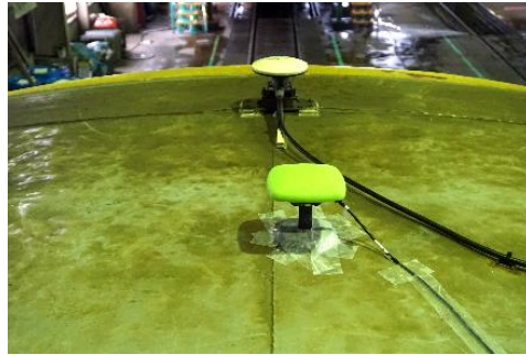
準天頂衛星等衛星測位システムの効果検証に係る試験の様子
