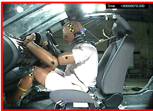
作動時の乗員挙動計測（被験者試験） AEB 作動時の乗員挙動計測（スレッド試験）
