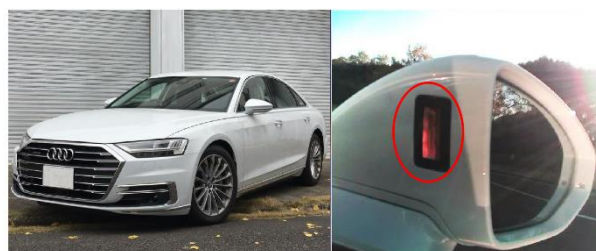
図 1 実験車両の外観と、車外物体認知の表示装置の一例
