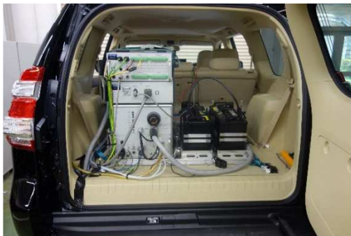
＜車載式排出ガス測定システム＞ ＜シャシダイナモメータ測定の様子＞
