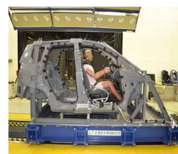
スレッド試験でダミーの挙動及び傷害値を調査
