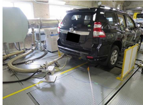
＜車載式排出ガス測定システム＞ ＜シャシダイナモメータ測定の様子＞
