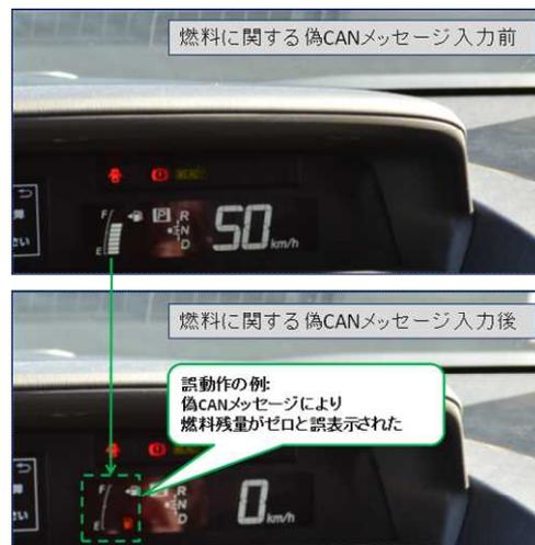
偽 CAN メッセージによる車両挙動変化の例
