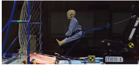
道路運送車両法の保安基準に適合しないチャイルドシートの調査実験
