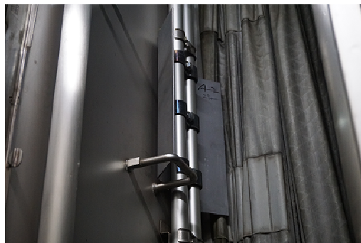
試験用に製作した磁界低減シールド
