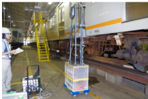
鉄道車両外部における磁界の測定状況
