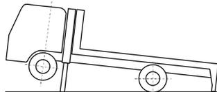
(自動車を積載する自動車であつて、低床荷台のために突入防止装置を備えるスペースが無いもの)
