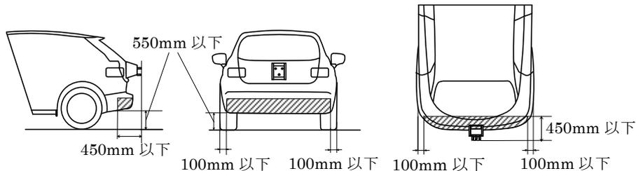
(車両後端から 450mm 以内の位置において、車輪の最外側から内側 100mm までの範囲を除く範囲にわたり、突入防止装置の構造部の地上高が 550mm 以下になっている。)
