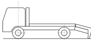
(重機及び自動車等の積載を容易にするために、アウトリガにより自動車の前側を持ち上げ、車体後面部分が接地する構造により、突入防止装置を備えることができない自動車)
