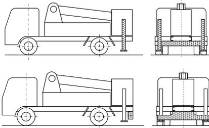
(2) 車両総重量が7t未満の自動車にあつては、リヤリフトゲート後面、塵芥車の荷箱後面その他の車体後面の構造部（(1)の例を含む。）が①から③までに掲げる要件に適合するものであること。
