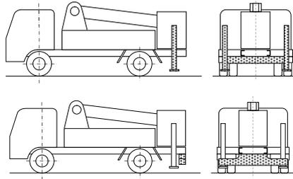
(2) 車両総重量が7t未満の自動車にあっては、リヤリフトゲート後面、塵芥車の荷箱後面その他の車体後面の構造部（(1)の例を含む。）が①から③までに掲げる要件に適合するものであること。
