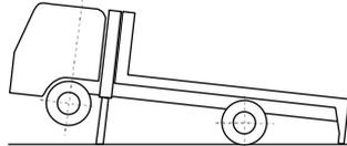
(自動車を積載する自動車であって、低床荷台のために突入防止装置を備えるスペースが無いもの)
