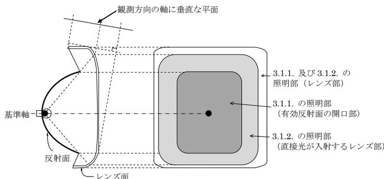
(2) 見通し要件の審査は、前部反射器、側方反射器及び後部反射器の場合には、3.1.4. で規定する反射部であつて、当該反射器の観測方向に垂直な平面に面する部分について行うものとする。
