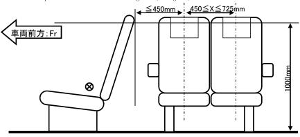
2.1. 最前部の横向き座席の基準面に基づく車両部分の高さは、1,020mm以上でなければなら ない(下図参照)
