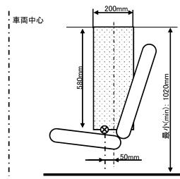
本H ポイントを通って垂直面に投影される車両部分の対応面は、当該有効衝突面の少なく 2.3. とも95%を覆うものとする。本車両部分は付録6のエネルギー吸収要件を満たすものとす る。
