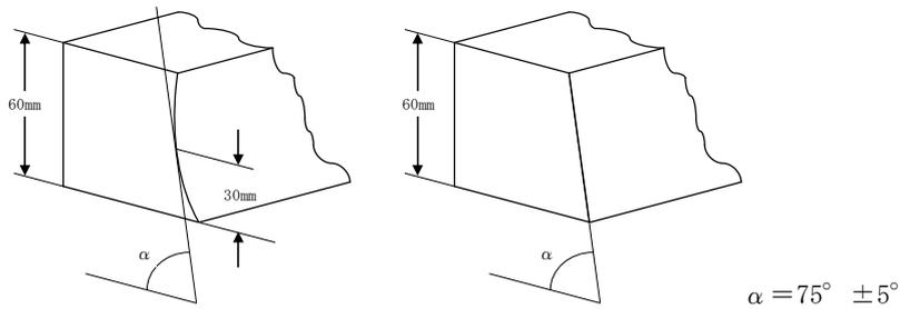
(3) 自動車の前後車輪の最外側輪と傾斜角度測定機の子輪止めは次の図のように接するよう配置し、測定するものとする。
