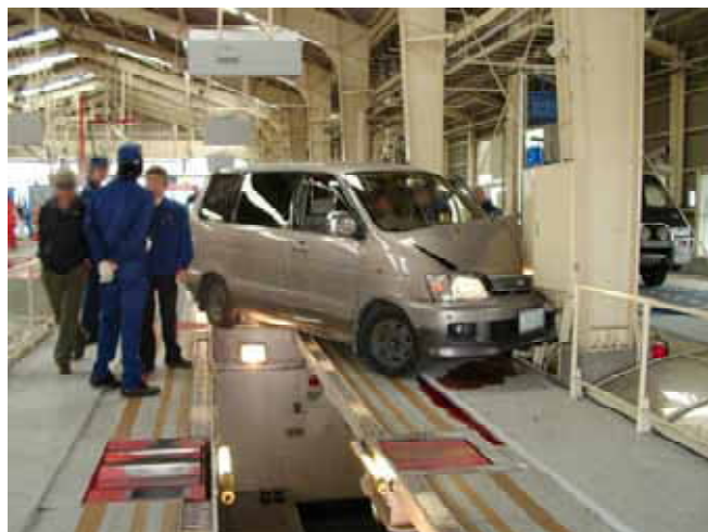
不適切な運転操作により、検査ラインをはずれてピット上で柱に衝突
